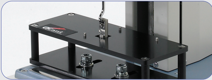
Micromodule Adhesion (pull test)
